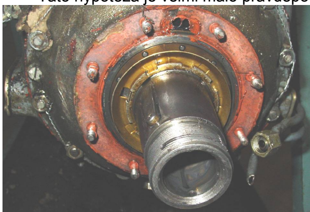
Obr. 3 Kuželový svěrný spoj a pero
